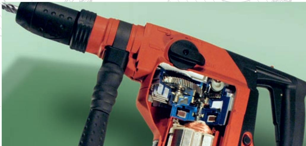
Rillenkugellager sind besonders geeignet für die Achslagerung von Elektromotoren
