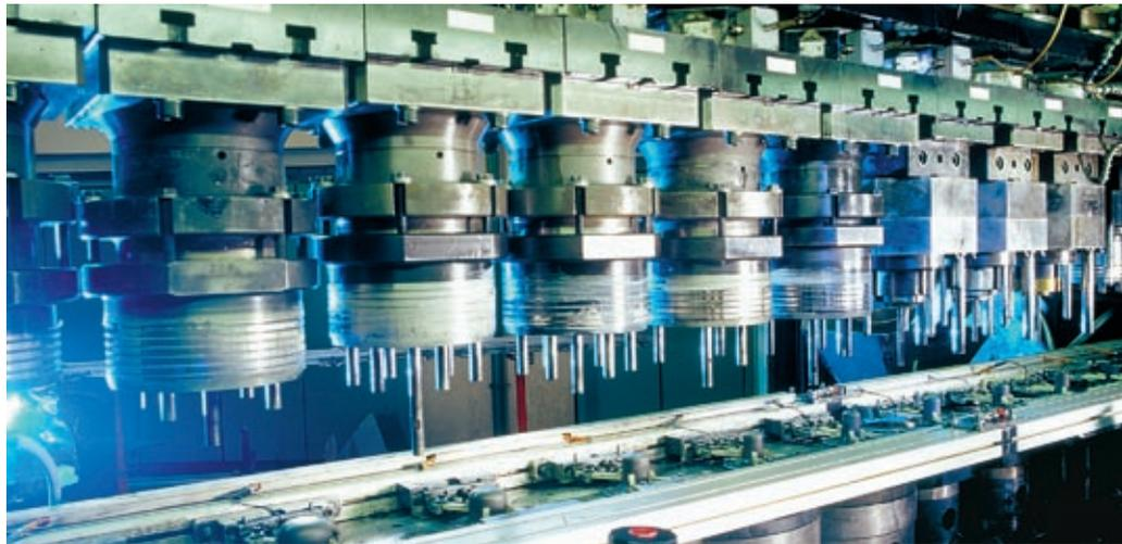
Stufenpresse: Hochentwickelte Tiefziehtechnik ermöglicht die kostengünstige Produktion von spanlos hergestellten Lagerkomponenten
