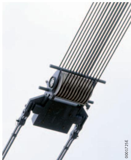
*Bild 2* · Seilscheibenlager am Beispiel S-Ausleger Verstellung, zwischen Ausleger und Derrickarm
