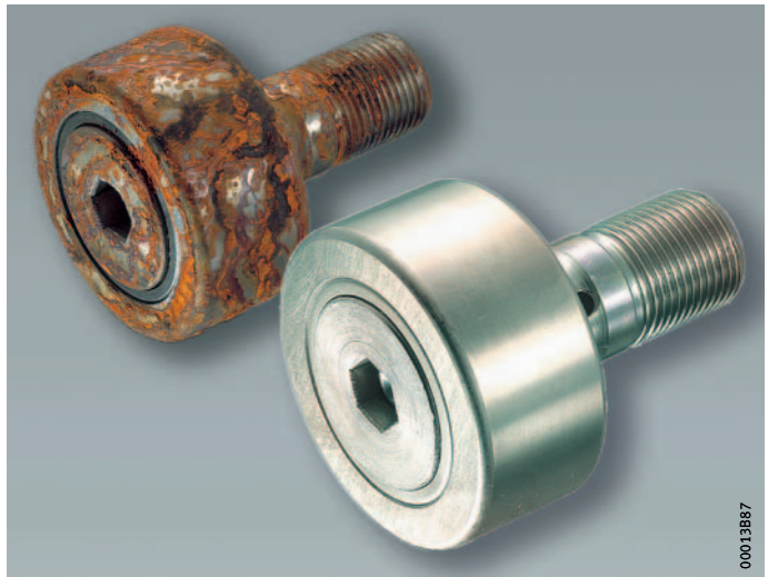
Bild 1 Corrotect A*-unbeschichtete und beschichtete Laufrolle nach Salzsprühnebelprüfung
