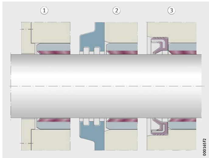
Bild 17 Dichtungen zum Schutz der Lagerstelle
