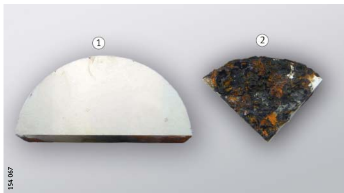
Bild 2 Korrosionsbeständigkeit, Vergleich nach 500 h Salzsprühtest
