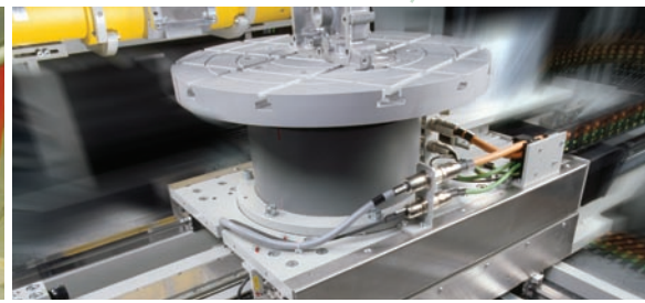
Präzisions-X-Y-Kreuztischsystem zum optischen Scanning
