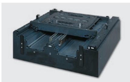
Luftgelagerter Präzisionskreuztisch für schnelle Laser-Feinstbearbeitung
