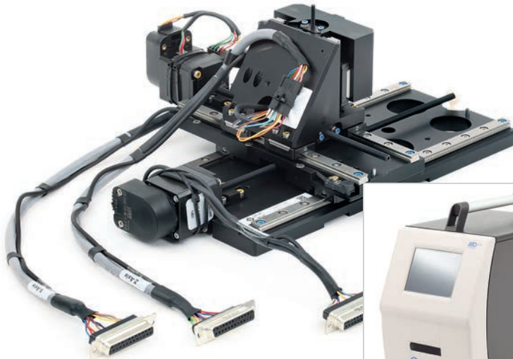
Im Diagnosegerät für Milchprodukte (rechts) werden die Analyseplättchen Verfahren. Die gesamte mechatronische Positioniereinheit (oben) kommt von Schaeffler
