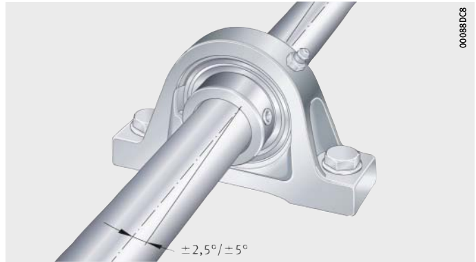
Bild 1 Kompensation statischer Fluchtungsfehler der Welle
