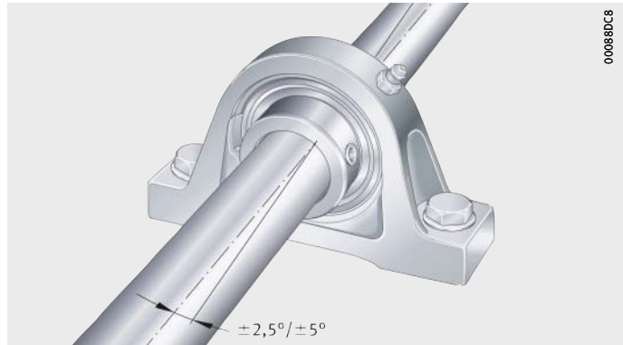
Bild 1 Kompensation statischer Fluchtungsfehler der Welle
