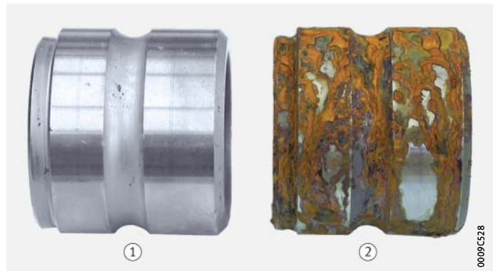
Bild 7 Beschichtetes und unbeschichtetes Teil nach Salzsprühnebelprüfung
