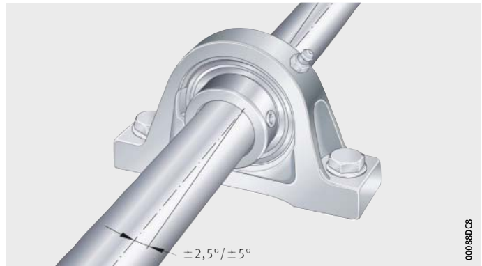
Bild 5 Kompensation statischer Fluchtungsfehler der Welle
