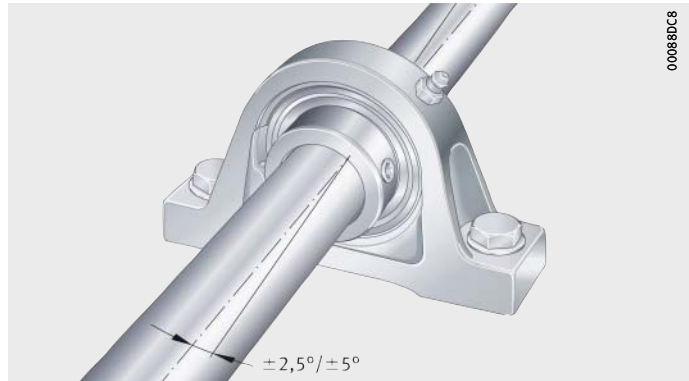
Bild 1 Kompensation statischer Fluchtungsfehler der Welle
