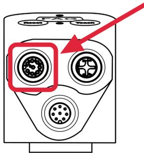
4. Verlegen Sie das Kabel, um es beispielsweise an einen externen Sensor oder eine Steuerung anzuschließen. Beachten Sie die Allgemeinen Hinweise [14] zum Verlegen der Kabel.
