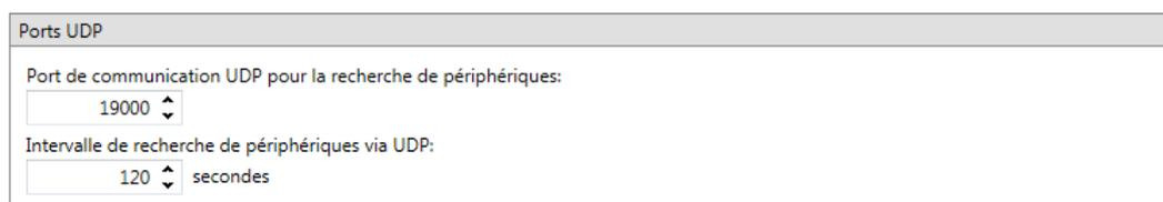
Par défaut, le port UDP est réglé pour la recherche des périphériques sur le port 19000. L'intervalle de recherche est réglé sur 120 secondes.
