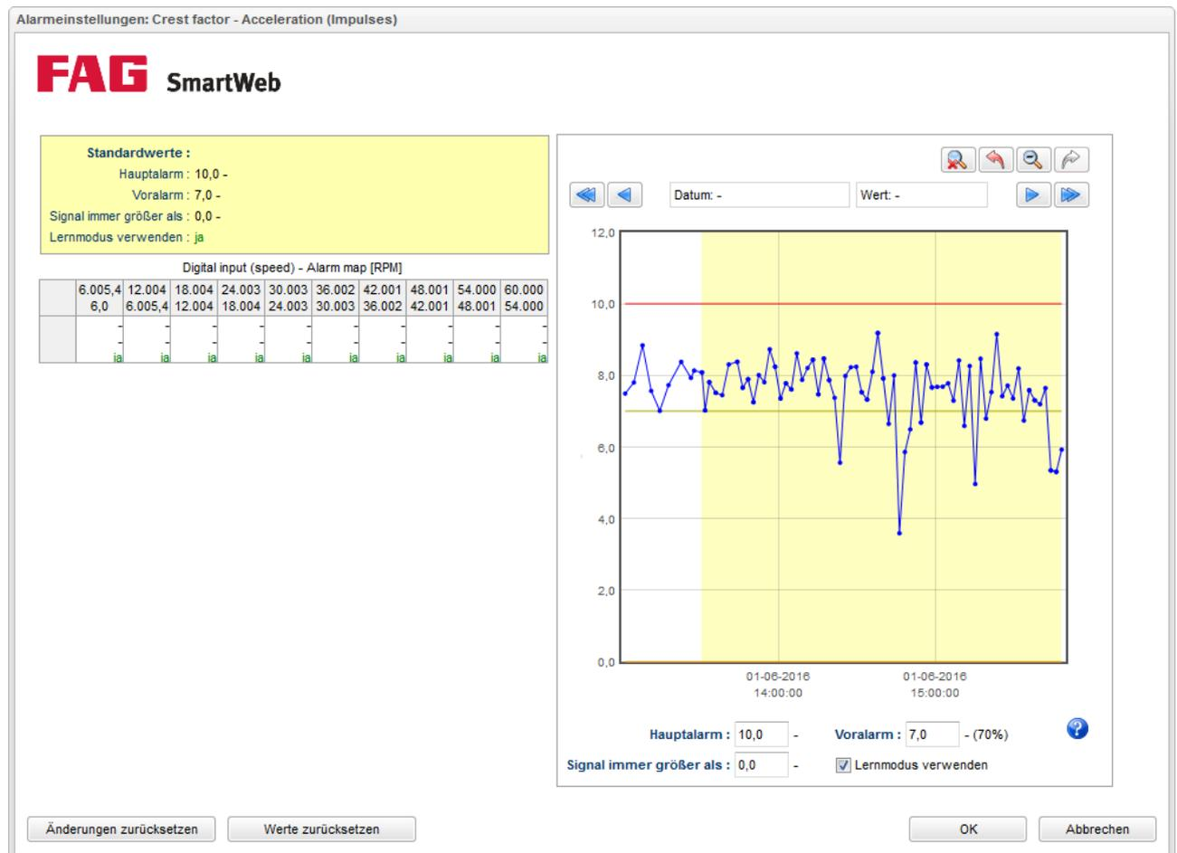
Für jedes dieser Alarmfelder nimmt das SmartCheck Gerät 1000 Messwerte auf, um daraus eine eigene Alarmschwelle für das entsprechende Alarmfeld auszurechnen.
