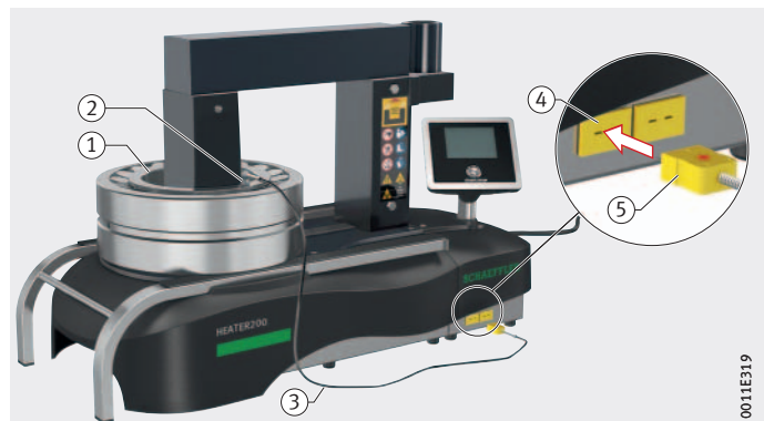
Bild 41 Temperaturfühler anschließen und anbringen
