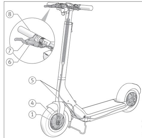
1 Konzentrischer Bremszylinder, 2 Bremsscheibe, 3 Bremsbelag, 4 Felge, 5 Bremsleitungen, 6 Bremsgriffe, 7 Bremshebel, 8 Lenker
