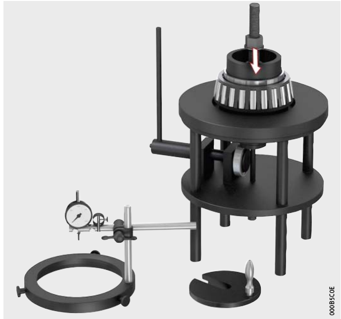
Bild 8 Innenring auf Zentrierbuchse aufschieben
