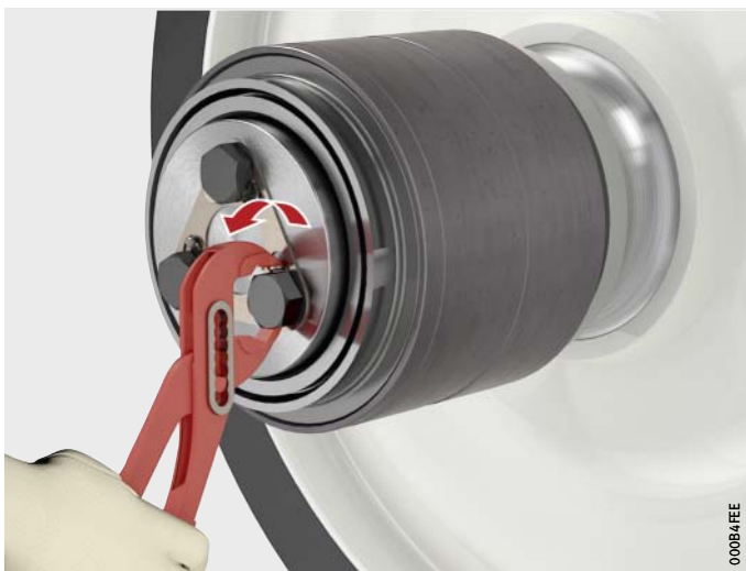
Bild 10 Lappen des Sicherungsblechs umbiegen
