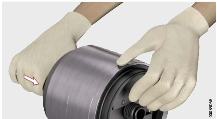
Bild 11 Stempel durch die Lagerbohrung führen
