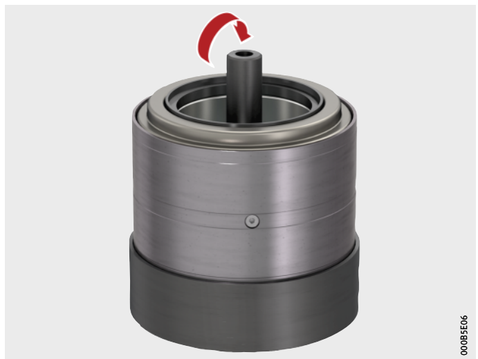
Bild 18 TAROL-Einheit mit Auspress- werkzeug in Aufnahmeric und Stempel mit Stempelplatte
