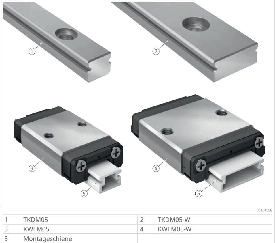
**!** Die Führungswagen werden immer direkt von der Führungsschiene auf die Montagesschiene geschoben und bleiben dort bis zur Wiedermontage. Die Montagesschiene aus Kunststoff verhindert Schäden am Wälzkörpersatz und das Herausfallen von Wälzkörpern, wenn der Führungswagen von der Führungsschiene getrennt wird. Bei Montage oder Demontage beachten, dass die Montagesschiene immer in Kontakt mit der Führungsschiene ist, um Wälzkörperverluste zu vermeiden.
